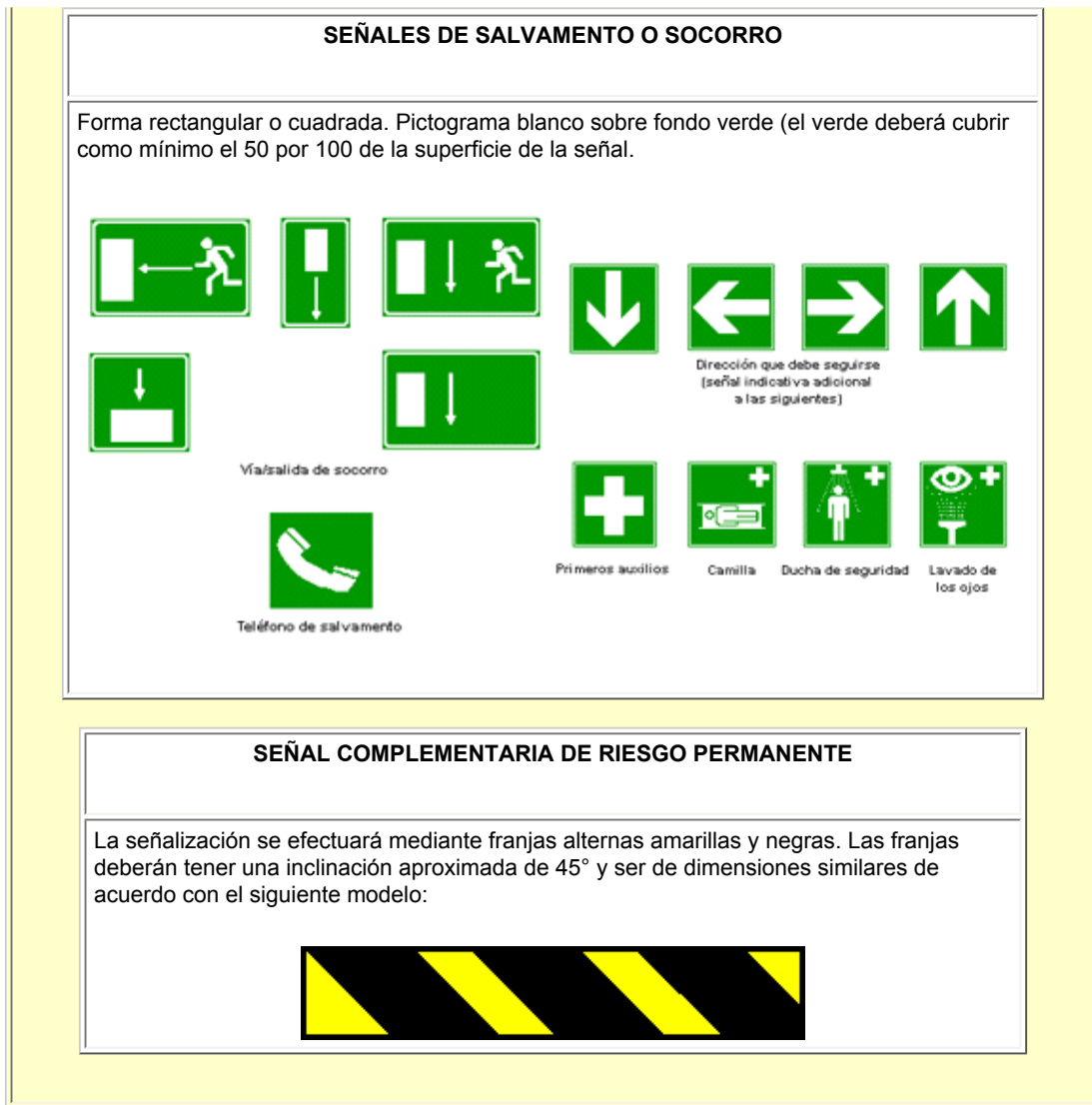
Figura 2. Tipos de señales panel según el Anexo III del R.D. 485/1997
